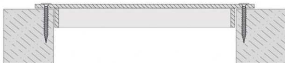
Открытое крепление с помощью саморезов
