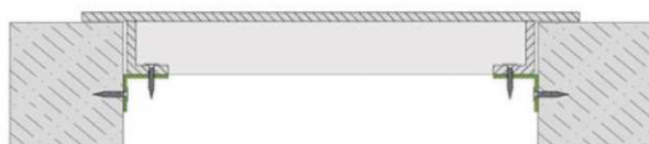
Скрытое крепление с помощью монтажного уголка (МУ)
