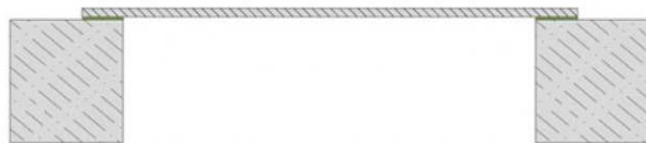
Скрытое крепление с помощью каучукового клея
