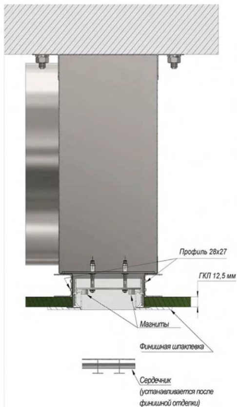
Монтаж щелевой решетки ARS-Line-TS
