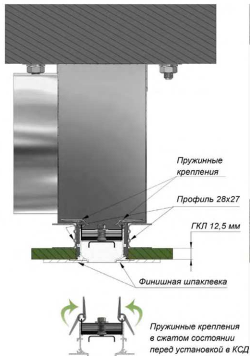
Монтаж щелевой решетки ARS-LOOK со стандартной камерой
